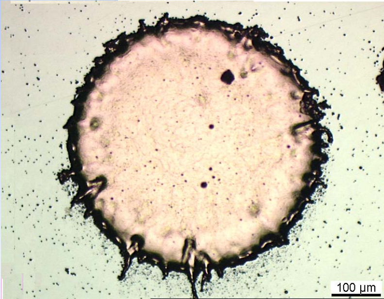
Ecrasement d'une particule de cuivre sur substrat métallique
