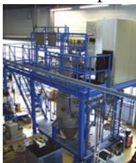
Production de particules métalliques sous jets gazeux
