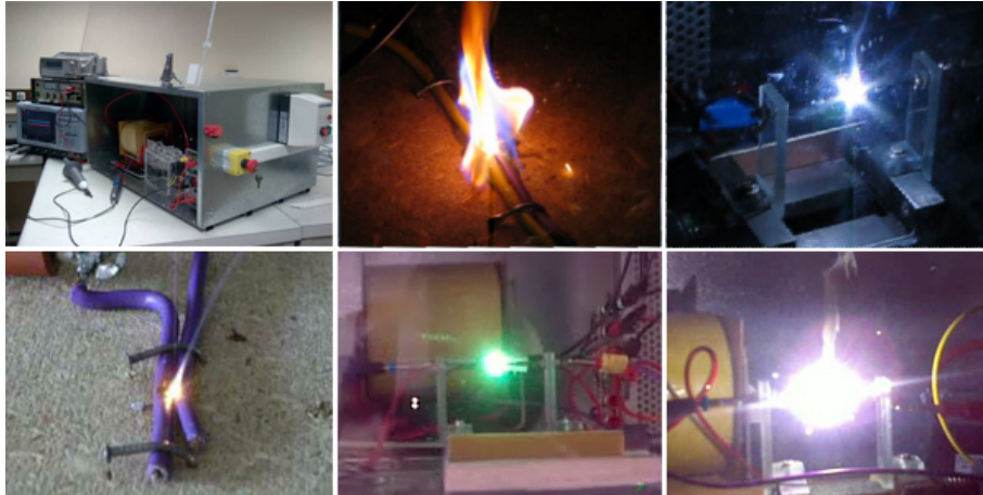
Générateur de défauts d'arcs reproductibles et calibrés (GDARC)
